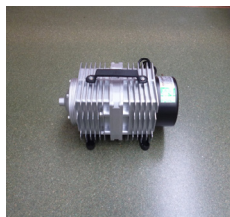
Compresor de aire
